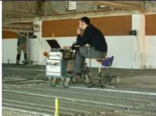
Steuergeräte für die Magnetisierung und das Vermessen des Magnetfelds sowie PC zu Datenerfassung und -auswertung
